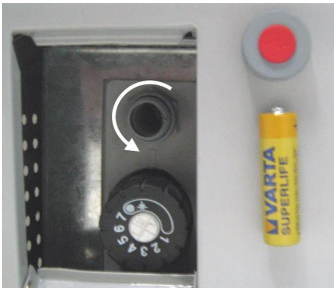
Ваш обогреватель может быть оборудован системой пьезорозжига (без использования батарейки) или электророзжига (со стандартной «пальчиковой» батарейкой типа АА). Преимуществом пьезо-запуска является отсутствие расходных материалов, а электро-запуск более комфортен и прост в работе, так как дает искру все время, пока Вы держите кнопку розжига.
