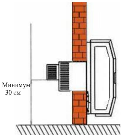
**Рисунок 1А: Расстояние отверстия дымовой трубы от земли.**
