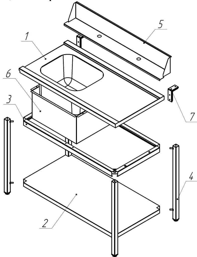
1. Установить в рамку (поз.3) стойки (поз.4) и закрепить при помощи гаек M10, шайб и гроверов.
