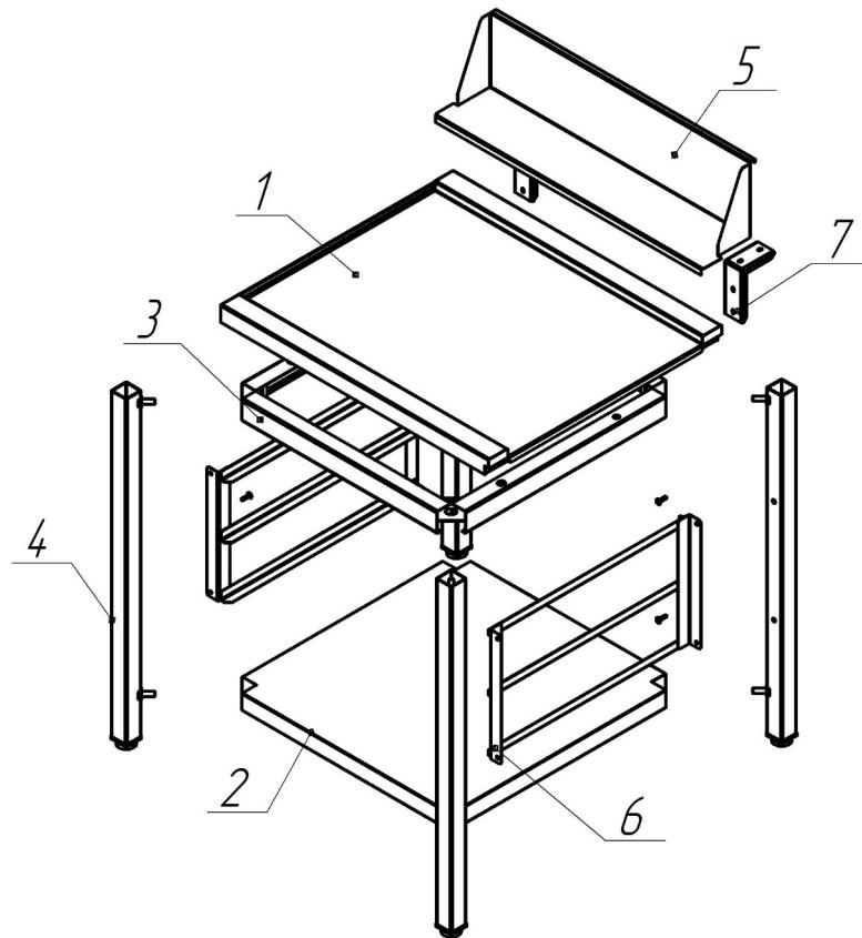
1. Установить в рамку (поз.3) стойки (поз.4) и закрепить при помощи гаек M10, шайб и гроверов.
