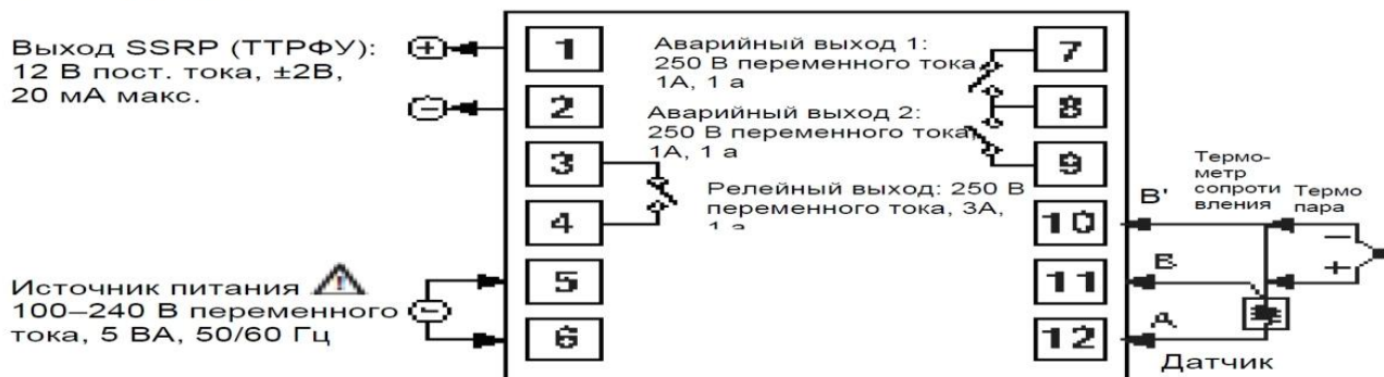
Рис. 9. Электрическая схема температурного контроллера.
